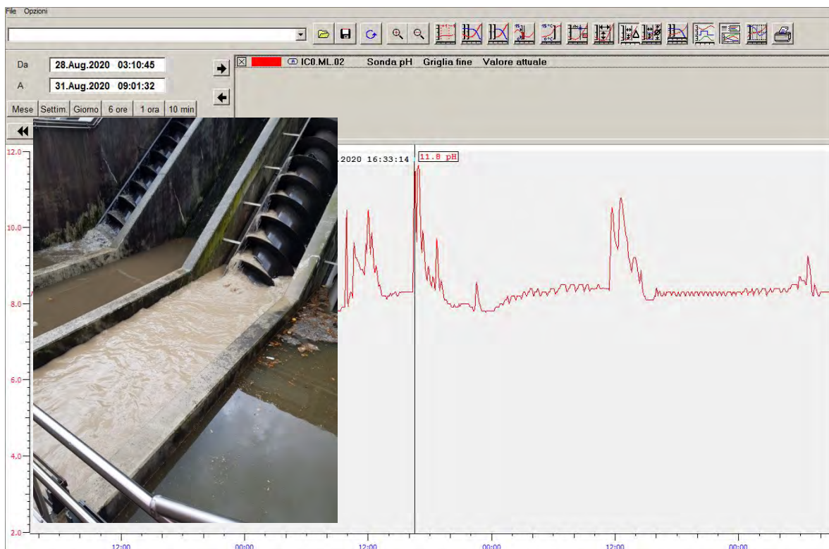
Figura 9 – Inquinamento da residui cementizi con aumento del pH (29-30 agosto 2020).
