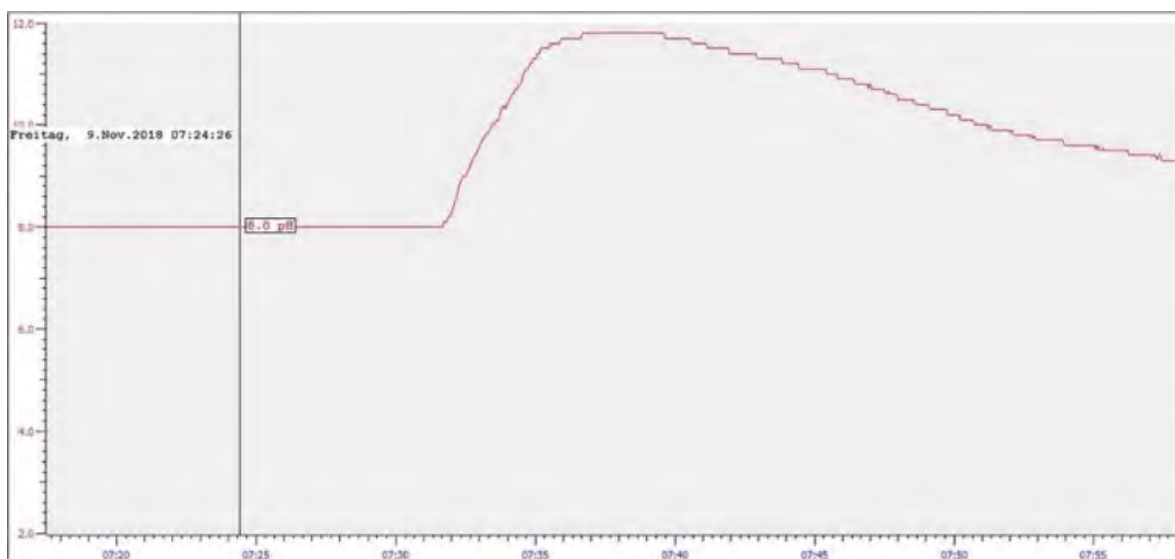
Figura 22 - Forte aumento del pH in entrata (estratto da supervisione).
